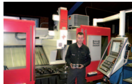
Guido Klaassen bij de RS 505 K18 van Hedelius; in zijn handen houdt hij een uit één stuk aluminium gefreesd complex onderdeel (luchtinlaat van een Porsche 356) dat op de machine is vervaardigd.
