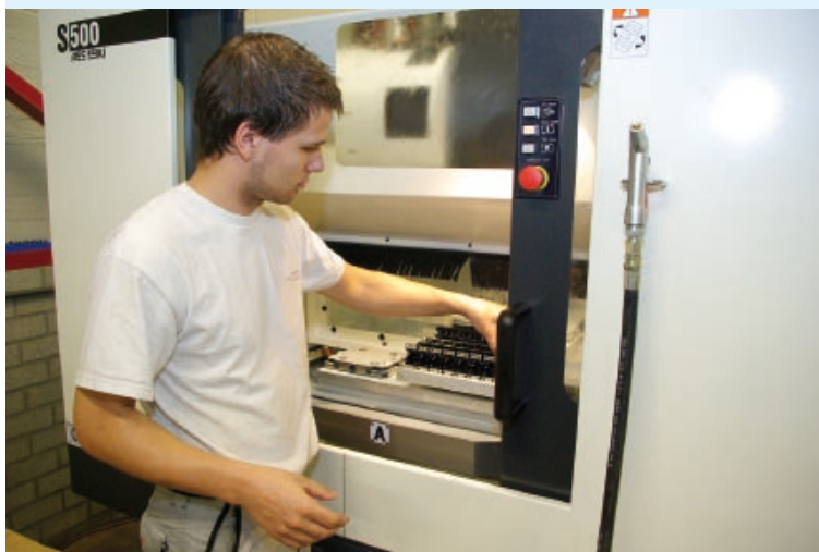
Het boor- en tapcentrum heeft dankzij de palletwisselaar een hoge werktafel, wat de ergonomie ten goede komt.
