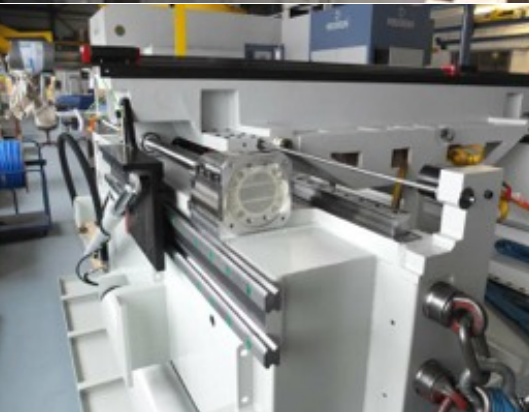
Vlnr met de klok mee: RX18 gereedschap- magazijn, het machinebed, de bewerkingsruimte, de staander in opbouw.
