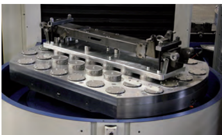
Met drie palletplaatsen is de Reiden voorbereid op automatisering met een robot
