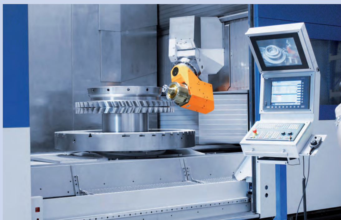
Optimaal zicht op gereedschap en werkstuk; een camera geeft de bewerking weer op een apart beeldscherm (foto: Reiden/Promas)
