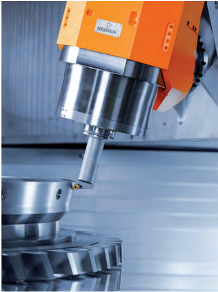
De RX18 leent zich ook goed voor nauwkeurig draaiwerk (foto: Reiden/Promas)
