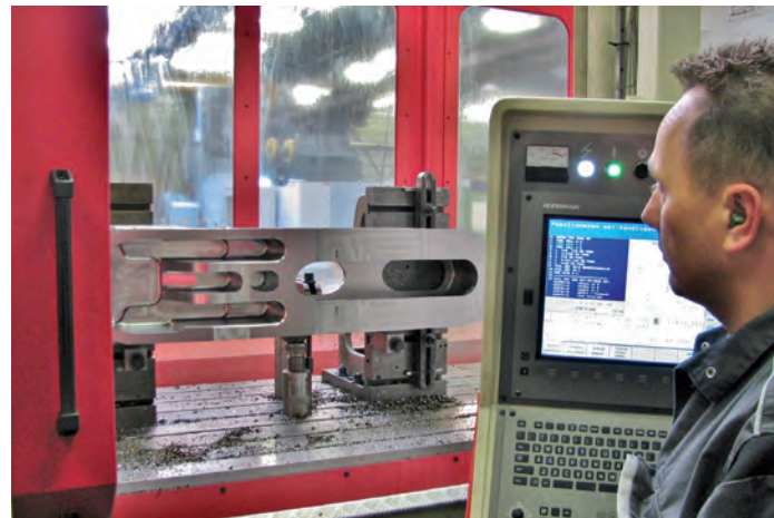
De KT-42 van MTE in bedrijf. Met het betreffende onderdeel zijn 150 uur aan freestijd gemoeid (foto: Jan Oonk)
