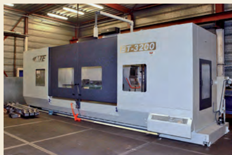
De BT-3200 bij Zandstra Metaalbewerking. De lineaire geleidingen zorgen voor een hogere dynamiek en nauwkeurigheid
