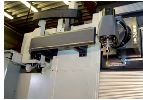
Direct naast de bewerkingskop bevindt zich het gereedschapmagazijn met veertig posities
