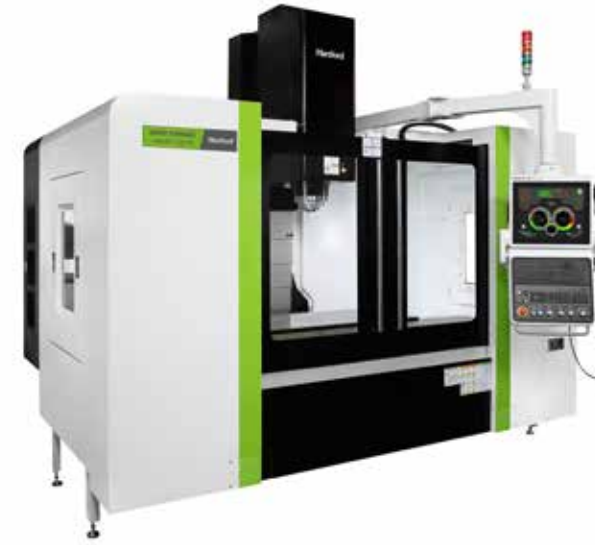
Promas présentera également le Hartford HCMC-1270/Oi, un centre d'usinage courant à trois axes équipé d'une commande Fanuc, d'un guide rectangulaire et d'une transmission par réducteur.
