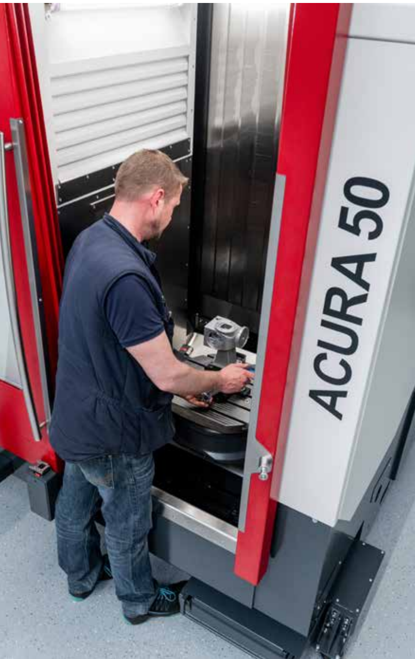
Dans l'Acura 50 de Hedelius, les solutions d'automatisation sont également mises en œuvre par le côté, de sorte que l'avant reste accessible à l'opérateur.
