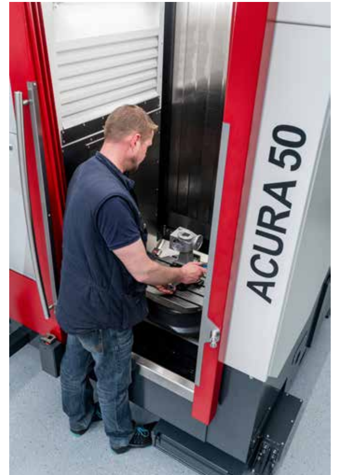
De automatiseringsoplossingen worden bij de Acura 50 van Hedelius overigens langs de zijkant geïmplementeerd, zodat de voorkant toegankelijk blijft voor de bediener.
