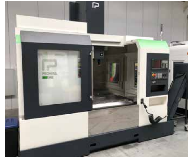
De PMT-1050 komt naar Machineering met lineaire geleidingen een spindel van 12.000 tpm, kortom een zeer complete machine, die qua prijs-kwaliteitverhouding zijn weerga niet vindt op de markt.
