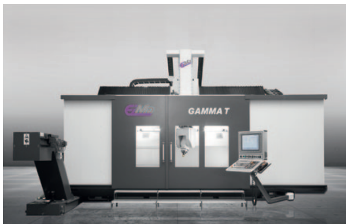
EiMa heeft met name machines voor het vijfassig bewerken van volumineuze onderdelen uit diverse materialen.
