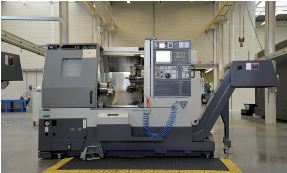
De nieuwe TA15 bij Abbink Metaal. Deze nieuwe TA-serie is uitgevoerd met een nieuwe omkasting (IP55 protectie) en een servogestuurde tegencentra
