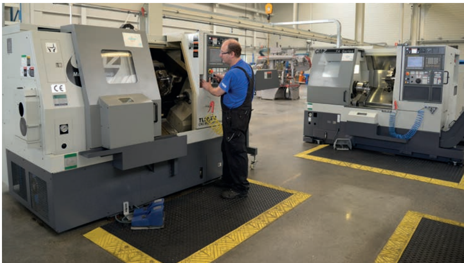
De beide draaimachines van CMZ in bedrijf, met links de TL20TM en rechts de nieuwe TA15. De draaidiameter boven het bed bedraagt in beide gevallen 760 mm (foto's: Marian Oosterink)
