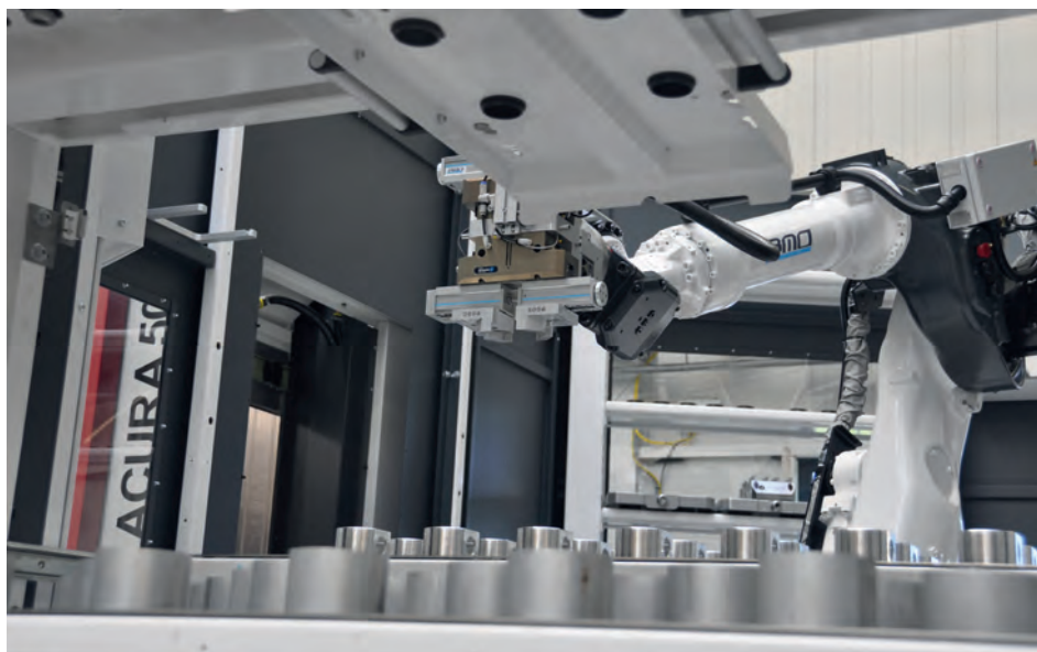
De BMO Titanium 180, tussen de Acura 50 en 65, zorgt bij deze 5-assers voor de aanvoer van de te bewerken materialen en de afvoer van bewerkte onderdelen.
