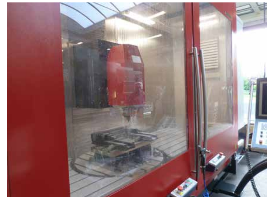
Dit systeem omvat een zwenkbare freeskop met snelheden tot 14000 toeren/minuut. De bereikbaarheid van de tafel is optimaal dankzij de ergonomie van deze Hedelius.
