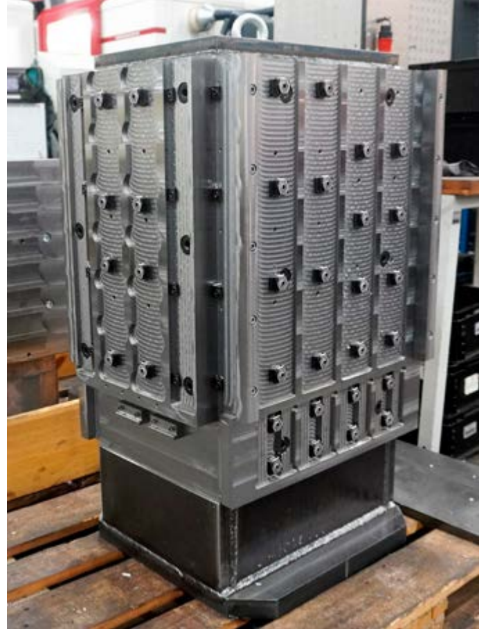
Om de Hedelius T7 in de onbemande te laten produceren, maakt Haak gebruik van een zelfontwikkelde toren waarop meerdere werkstukken opgespannen kunnen worden.
