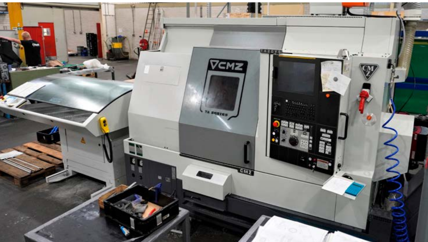
De CMZ TA20YS-640 met Irco Breuning stangenlader stelt Haak in staat om complexe draaidelen onbemand en compleet te bewerken.
