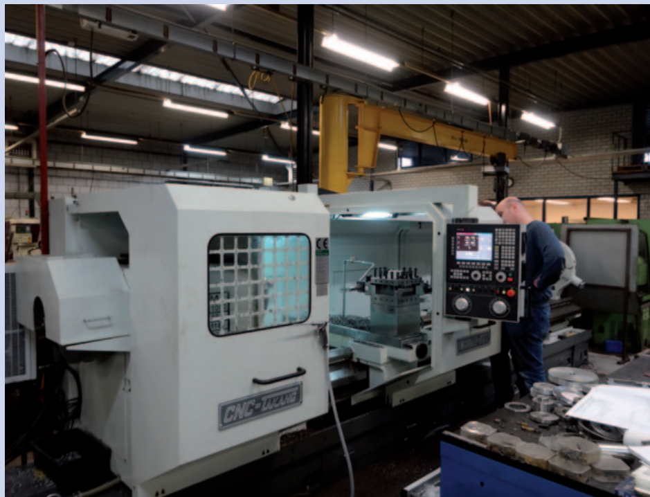
De Takang TNC890A stelt Hamers Metaalbewerking in staat om werkstukken met een lengte van 4 m en een diameter tot 900 mm te bewerken. Met deze capaciteitsuitbreiding kan Hamers nieuwe klanten en aanvragen werven (foto's: Tim Wentink)
