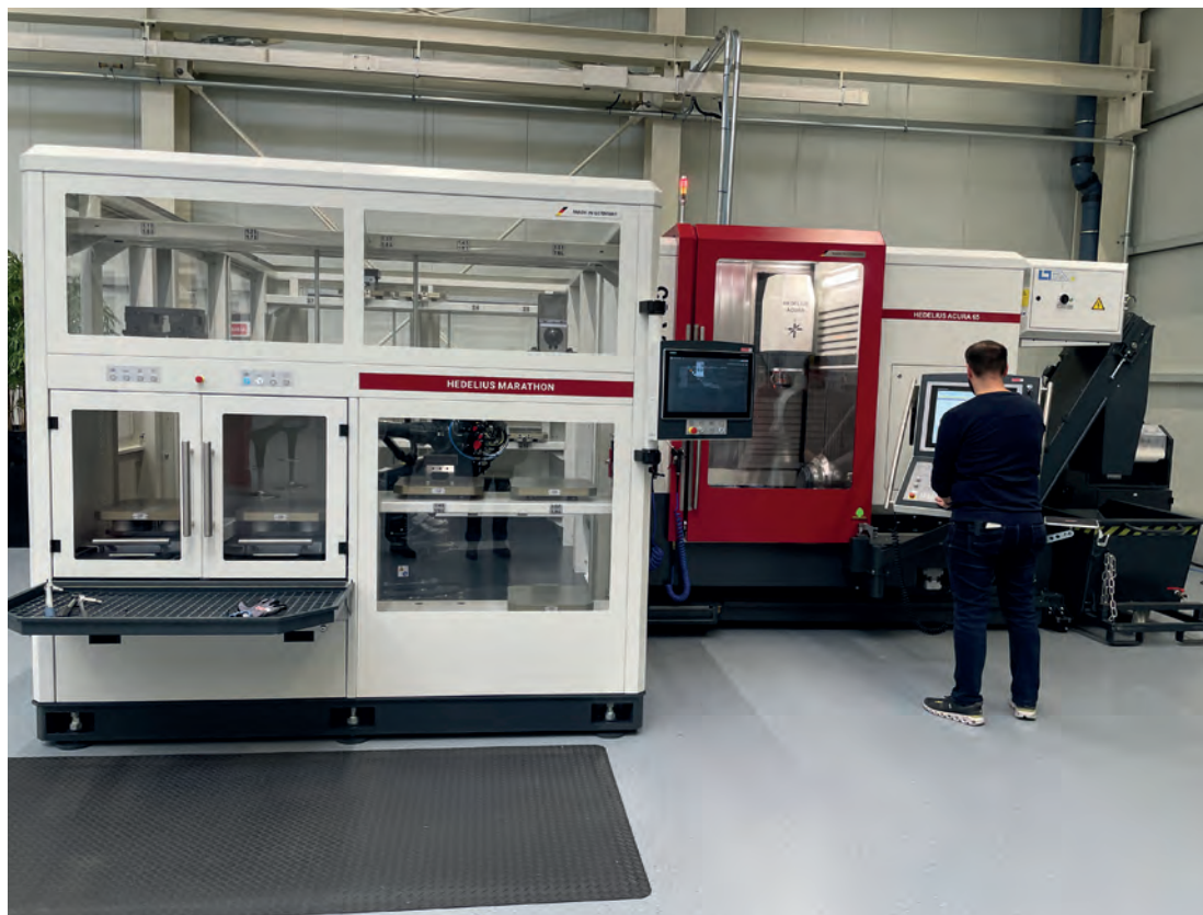
De beladingscel Marathon RZ 430 gekoppeld aan het 5-assige Acura 65 bewerkingscentrum in het technologiecentrum van Hedelius in Meppen.
