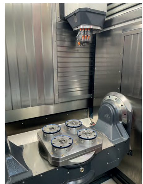
Het nulpuntspanstelsysteem van de Acura 65.
