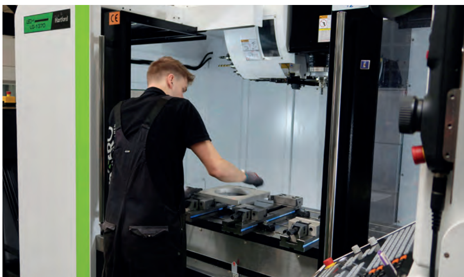
Het bewerkingscentrum van Hartford biedt dankzij het 1300 mm bereik in de X-as ruimte aan zowel grotere onderdelen als aan meerdere klemmen.
