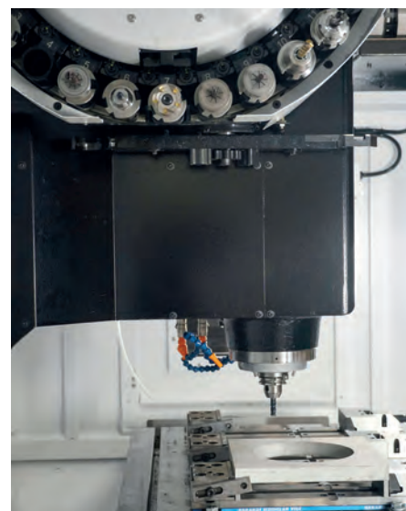
De nieuwe Hartford beschikt over een automatische gereedschapswisselaar met in totaal 30 posities voor SK40 opname. De andere machines van Acero zijn voorzien van SK50 opname.
