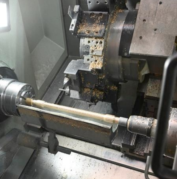
Le nouveau tour mesure 1.100 mm entre les pointes, soit presque le double de la machine précédente
