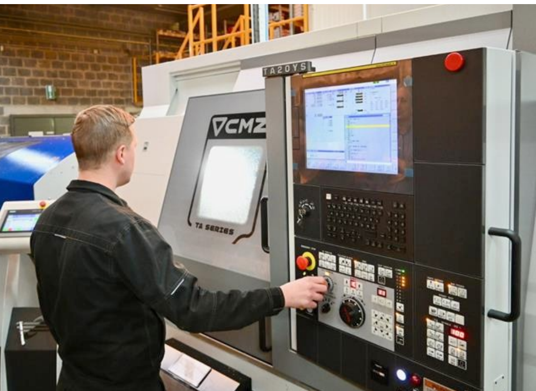
Le tour est équipé d'une commande Fanuc, tout comme les autres machines de l'atelier
