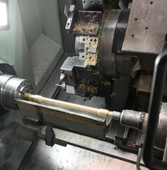
De nieuwe draaibank meet 1.100 mm tussen de centers, wat bijna een verdubbeling is ten opzichte van de vorige machine
