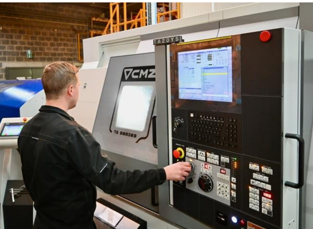
De draaibank heeft een Fanuc-sturing, zoals de andere machines in de werkplaats
