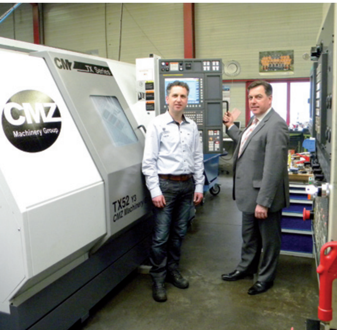
Henri Corstjens (links) en Alex de Gelder bij de TX52Y3-draaimachine van CMZ. Per week wordt de machine circa honderd uur onbemand en twaalf uur bemand ingezet.
