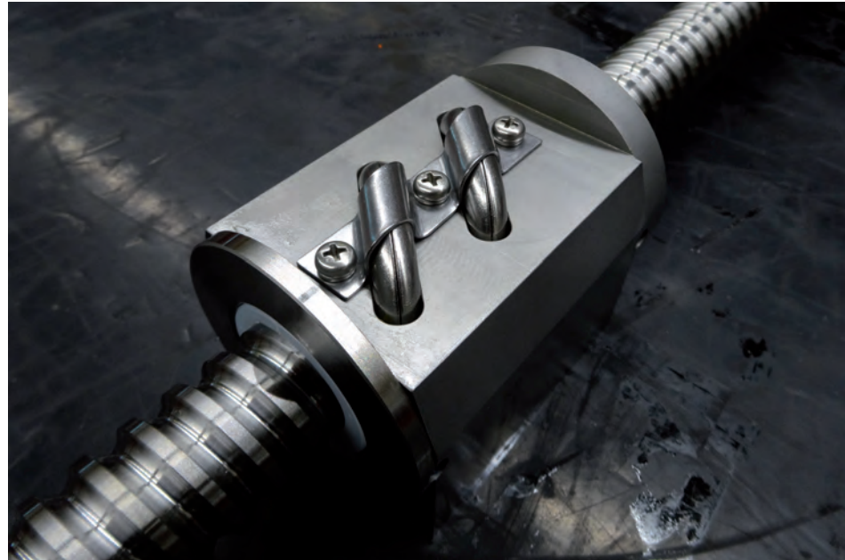
CMZ gebruikt uitsluitend kogelomloopspillen van NSK. De recirculatie aan de buitenzijde van de behuizing is ontwikkeld om de kogels zo lang als mogelijk in contact te houden met de spil (foto's: Tim Wentink)
