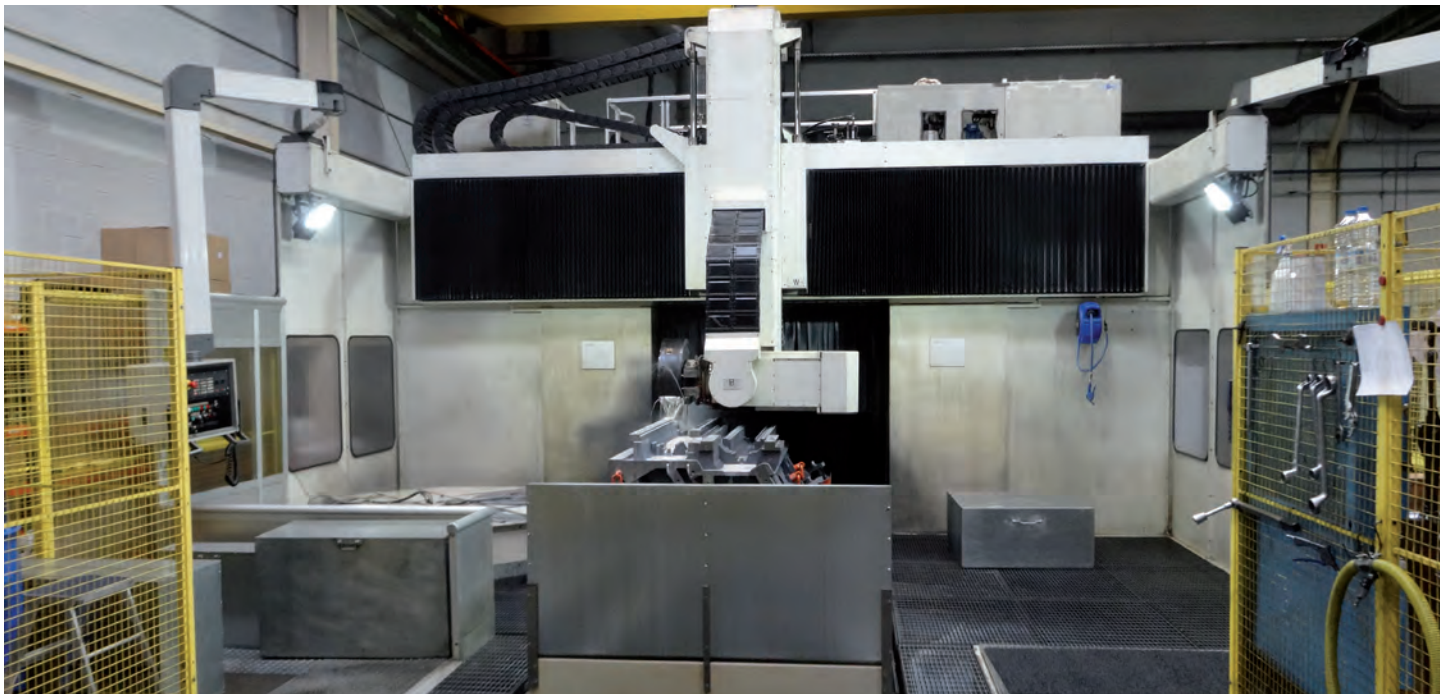
Voor het slijpen van frames heeft CMZ twee grote slijpmachines in gebruik. Het frame is ontworpen om vervorming bij het opspannen op de slijpmachine tegen te gaan. Het duurt acht uur om de geleidingen van een frame te slijpen. De meest belangrijke eigenschappen hierbij zijn paralleliteit, vlakheid en oppervlaktekwaliteit
