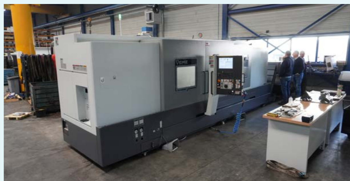
Naast de nieuwe portaal-freesmachine van Hartford heeft K&G Machining recent ook geïnvesteerd in een stabiele draaibank van CMZ. De TD35-Y-3.200 stelt de fabrikant in staat om draadelen met freesbewerkingen in één opspanning compleet te bewerken.
