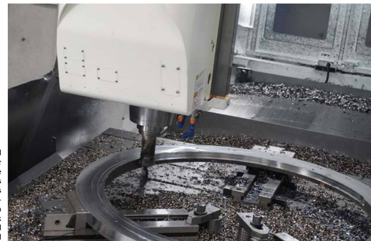
K&G Metal Service past egelfrezen toe om de binnen- en buitenkant van de ringen in één procesgang te bewerken. De stabiele Hartford met blokgeleiding is goed bestand tegen de hoge krachten die hierbij komen kijken.
