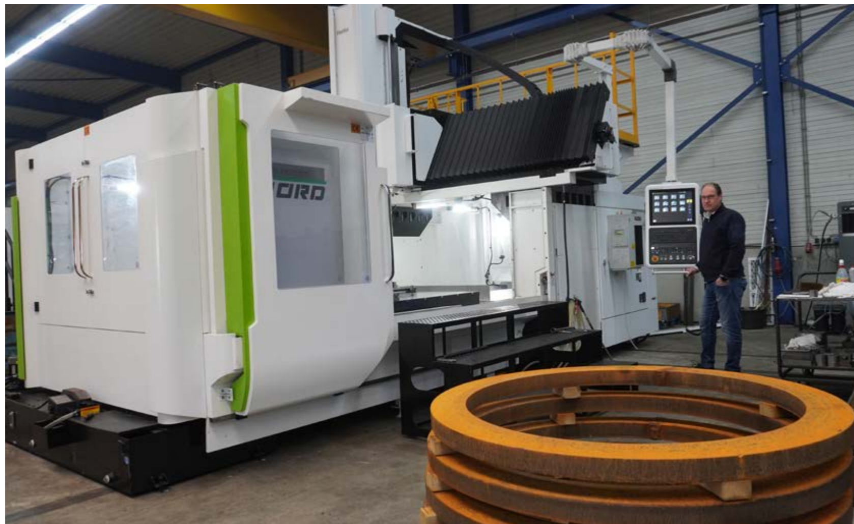
Edwin Klap, directeur van K&G Machining, naast de nieuwe Hartford SW-220 portaal-freesmachine. De machine wordt ingezet om grote ringen te bewerken tot flenzen.
