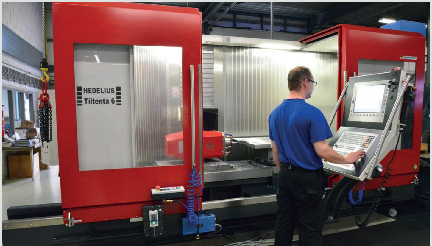
De nieuwe T6-2300 freesmachine in bedrijf bij Jadima. De spindel is in staat om over een hoek van \pm 98^\circ te kantelen zodat de matrijsdelen vijfassig bewerkt kunnen worden (foto's: Marian Oosterink)
