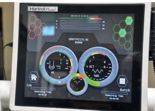
De Hartrol Plus1-besturing, een eigen ontwikkeling van Hartford, biedt een helder overzicht van wat de machine heeft gedaan, doet en nog moet doen.
