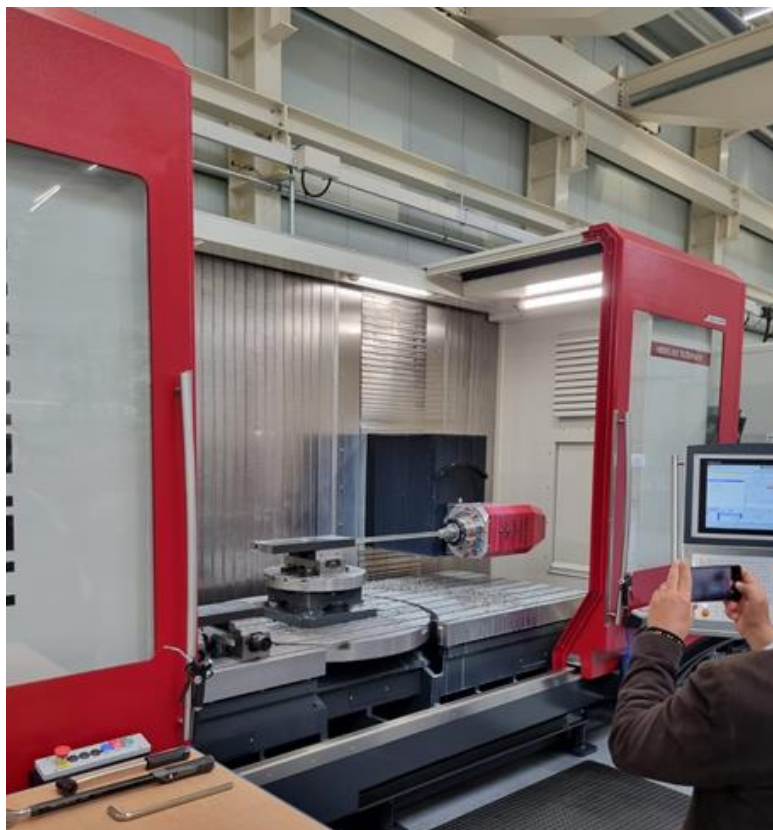
HEDELIUS Tilenta is een universele freesmachine en dynamisch bewerkingscentrum waar zowel kleine als grote werkstukken 5-assig mee afgewerkt kunnen worden
