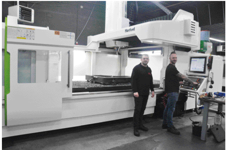
Bedrijfsleider Maikel Schapendonk (links) en CAD/CAM-programmeur/frezer Anne voor de nieuwe Hartford HSA-316. Deze machine heeft een bereik van 3.250 x 1.600 x 780 mm en een werkbladbereik van 3.000 x 1.400 mm, voor maximaal 10.000 kg.
